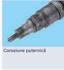
Coroziune puternică, deteriorări datorită apei sau combustibilului necorespunzător
