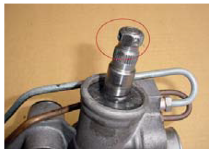
Dinții arbore deteriorați
