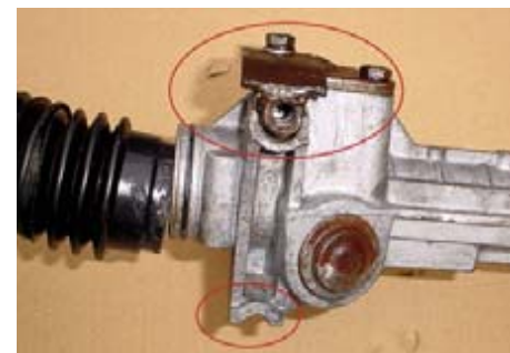
Puncte de fixare deteriorate
