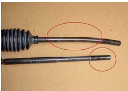
Biele de direcție deteriorate
