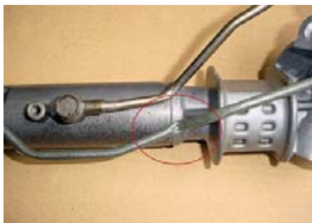
Conducte deteriorate sau lipsă
