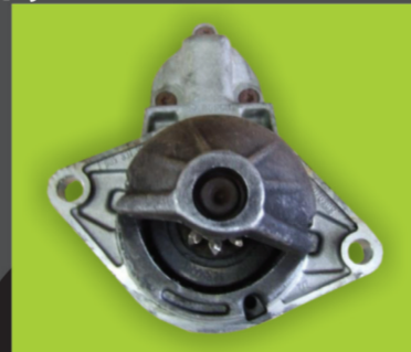
8. Semne de coroziune avansată pe pinion:
