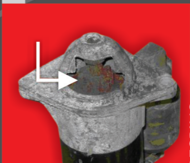
8. Semne de coroziune avansată pe pinion:
